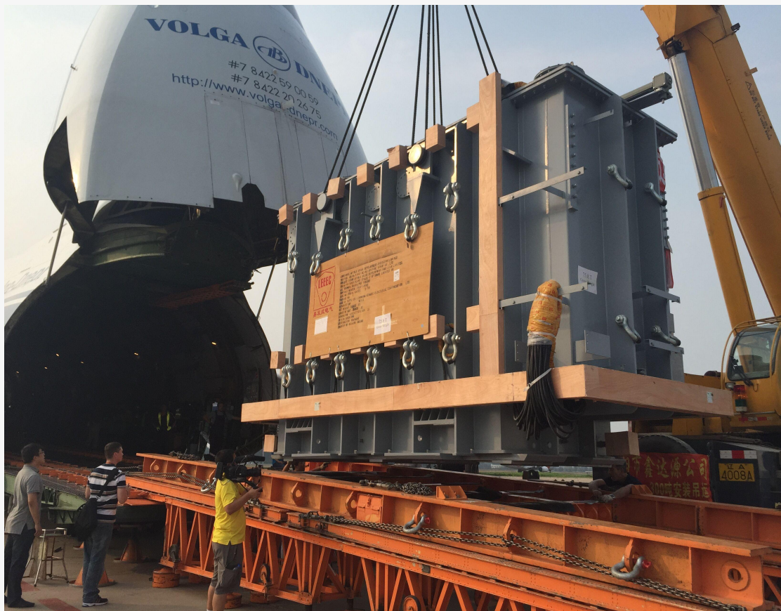
一带一路 中巴经济走廊 900MW光伏项目主变空运
